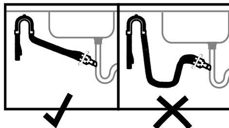
Assurez-vous que le tuyau d'évacuation s'insère en ligne droite dans le raccord afin que l'eau usée ne s'accumule pas dans le tuyau. Enlevez tout excédent du tuyau d'évacuation, si nécessaire. **Ne raccourcissez pas le tuyau d'alimentation.**
