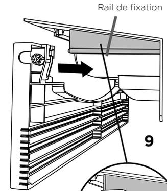
Glissez la plinthe sur les rails de fixation de chaque côté, puis vissez-la dans le bas de la cuve sur chaque côté.
