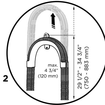
Raccord de tuyau d'évacuation fourni adapté au té d'évacuation Ø 3/4" (19 mm)
