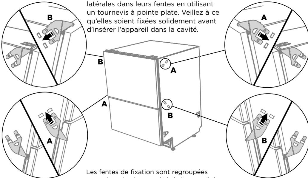
Les fentes de fixation sont regroupées par paires de chaque côté de l'appareil, à la diagonale. La pièce **A** doit être insérée dans la fente **A**, et la pièce **B**, dans la fente **B**.
