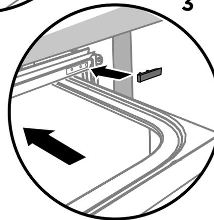
Réinsérez le bouchon en caoutchouc gris dans la moulure en veillant à ce que le joint soit orienté vers l'avant.
