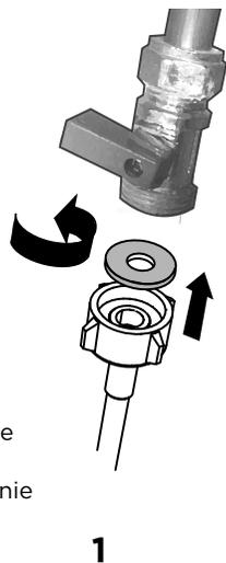
Assurez-vous que la rondelle en caoutchouc fournie est insérée dans le raccord.
