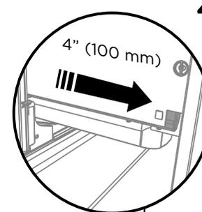
Tirez vers l'avant les languettes de dégagement des deux côtés de 4" (100 mm). Assurez-vous que les languettes soient entièrement tirées vers l'avant et enclenchées.
