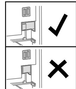
Tirez vers l'avant les languettes de dégagement des deux côtés de 4" (100 mm). Assurez-vous que les languettes soient entièrement tirées vers l'avant et enclenchées.
