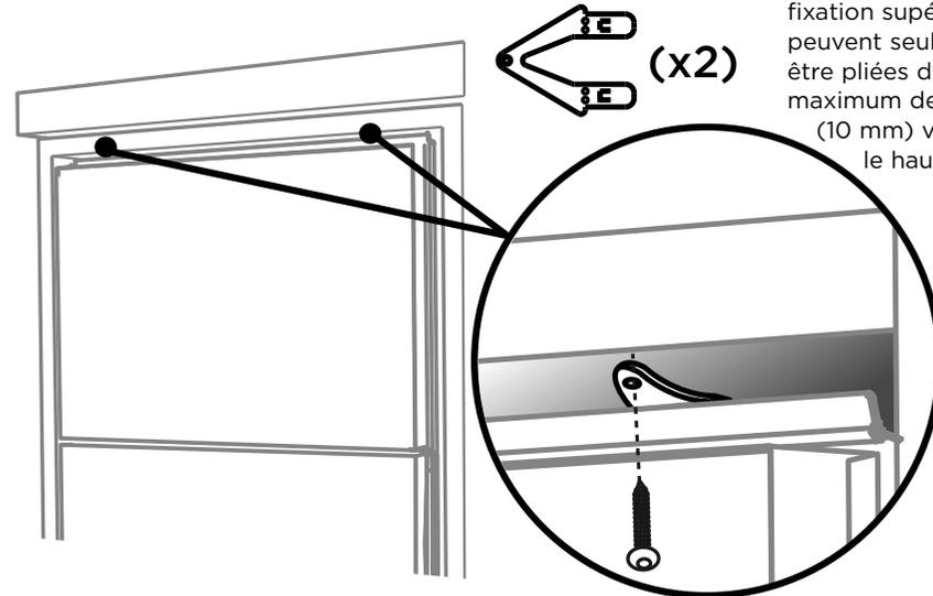
Les pièces de fixation supérieures peuvent seulement être pliées d'un maximum de 3/8" (10 mm) vers le haut.
