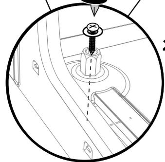
une paire d'ouvertures de fixation sur les côtés du fond (utilisez des vis de fixation de 1 1/2" (38 mm) et des rondelles)
