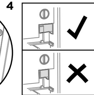
Tirez vers l'avant les languettes de dégagement des deux côtés de 4" (100 mm). Assurez-vous que les languettes soient entièrement tirées vers l'avant et enclenchées.
