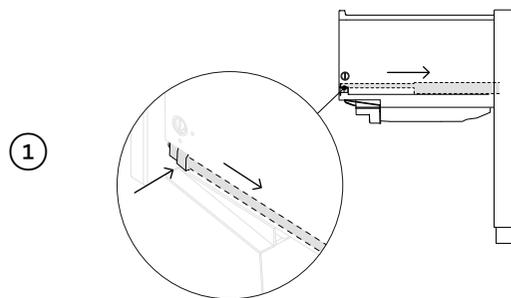
1 Abra el cajón y presione las dos lengüetas de bloqueo hacia atrás para soltarlo.
