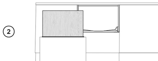
2 Levante el cajón para retirarlo de las guías y apártelo a un lado con cuidado sobre una superficie protegida. Vuelva a introducir las guías.
