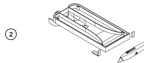
En una superficie protegida, corte y retire con cuidado los clips de la ventilación como se muestra. Vuelva a colocar la cubierta superior.
