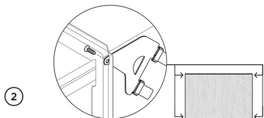
2 Fije al armario con los soportes. Es posible que sea necesario taladrar previamente un orificio de guía dependiendo del material del armario.
