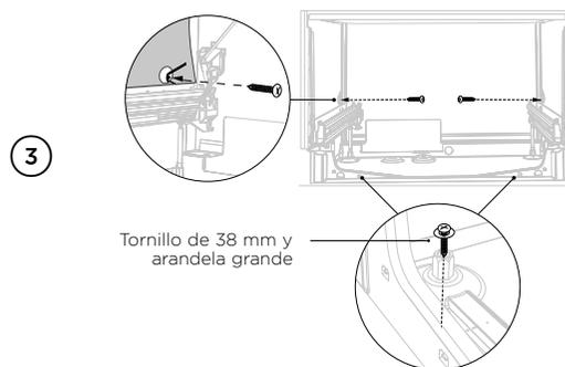
3 Sujete al armario a través de las tres ubicaciones de fijación del chasis.
