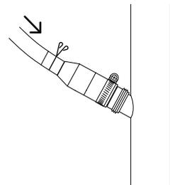
Pase la presilla de alambre sobre la manguera antes de tirar de la manguera a través de la guía de soporte y de la conexión al racor de manguera suministrado. Sujete con la presilla de alambre.
