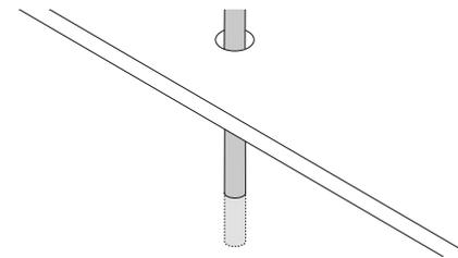
Pase la manguera de ventilación a través del suelo. Asegúrese de haber retirado el exceso de manguera.
