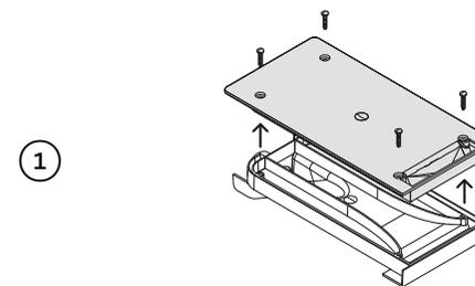
Desenrosque la cubierta superior de la ventilación y apártela a un lado.
