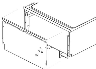
Tire con cuidado del soporte hacia abajo y fuera del lavavajillas DishDrawer™ y desconecte el módulo Knock-to-Pause y el cable de toma de tierra.
