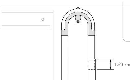
Tire de la manguera a través de la guía de soporte y apóyela en el tubo vertical. Asegúrese de que la manguera no se extienda más de 120 mm en el tubo vertical para evitar que las aguas residuales vuelvan a la cuba.
