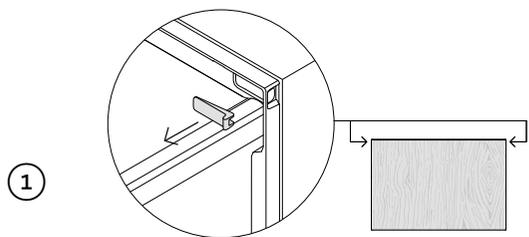
1 Abra parcialmente uno de los cajones y retire la primera cubierta del tornillo de la moldura.
