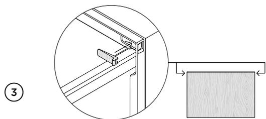
3 Vuelva a colocar la cubierta de la moldura y repita el procedimiento para los soportes restantes.
