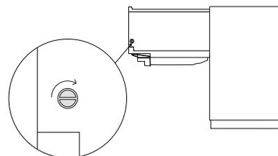
Vuelva a insertar los dos pasadores laterales en cada cajón empujando y girando un cuarto de vuelta hacia la parte posterior del aparato para sujetar los paneles en su sitio.
