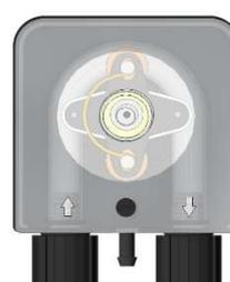
**Presentar la tapa de la bomba, respetando las flechas, y luego atornillar el tornillo de fijación de la tapa frontal.**
