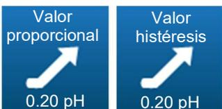
Cuando se configura la dirección de dosificación del canal de pH en modo ascendente, dependiendo del modo de control previamente seleccionado, este botón se utiliza para seleccionar el valor de la banda proporcional o el valor de histéresis.
