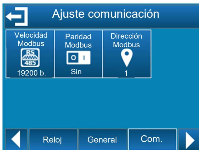
Puedes cambiar la velocidad de comunicación, la paridad y la dirección del modbus (id de esclavo) seleccionando cada botón.
