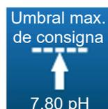
Este botón se utiliza para establecer el punto de ajuste máximo del canal de pH que se puede introducir en el modo de usuario.
