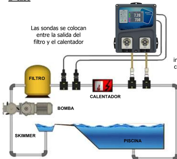
Los collares de inyección química se colocan después del calentador
