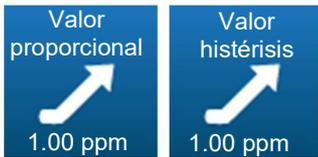
Cuando la dirección de dosificación del canal de cloro está configurada en modo ascendente, en función del modo de regulación previamente seleccionado, este botón permite seleccionar el valor de la banda proporcional o el valor de la histéresis.
