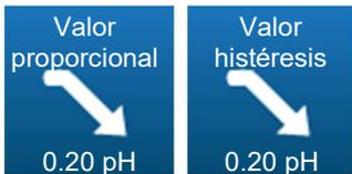
Cuando se configura la dirección de dosificación del canal de pH en modo descendente, dependiendo del modo de control previamente seleccionado, este botón se utiliza para seleccionar el valor de la banda proporcional o el valor de histéresis.
