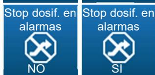
Este botón se utiliza para activar o desactivar el corte de dosificación cuando hay una alarma técnica en el controlador (Alarmas de medición alta o baja).
