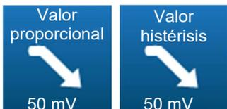
Cuando se configura la dirección de dosificación del canal redox en modo descendente, en función del modo de control previamente seleccionado, este botón se utiliza para seleccionar el valor de la banda proporcional o el valor de la histéresis.
