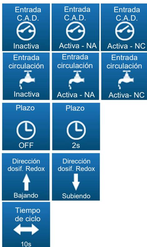
Este botón se utiliza para activar o desactivar la entrada de "control remoto". También te permite elegir la dirección del contacto NA (normal abierto) o NC (normal cerrado).
