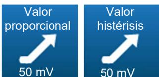
Cuando se configura la dirección de dosificación del canal redox en modo ascendente, en función del modo de regulación previamente seleccionado, este botón se utiliza para seleccionar el valor de la banda proporcional o el valor de la histéresis.
