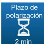
Este botón le permite introducir un retardo de inicio del sensor de cloro entre 0 y 480 segundos. Este retardo se utiliza para retrasar el inicio de la regulación y el procesamiento de las alarmas tras el arranque de la unidad o la desconexión del sensor. Durante esta fase el símbolo
