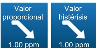
Cuando la dirección de dosificación del canal de cloro está configurada en modo descendente, en función del modo de regulación previamente seleccionado, este botón permite elegir el valor de la banda proporcional o el valor de la histéresis.
