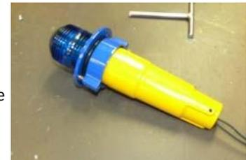
**NOTE:** la posición del empaque de la lente antes de retirarlo. El empaque establece un ángulo cuando se instala correctamente contra la superficie inclinada de la brida exterior de la cristalería.
