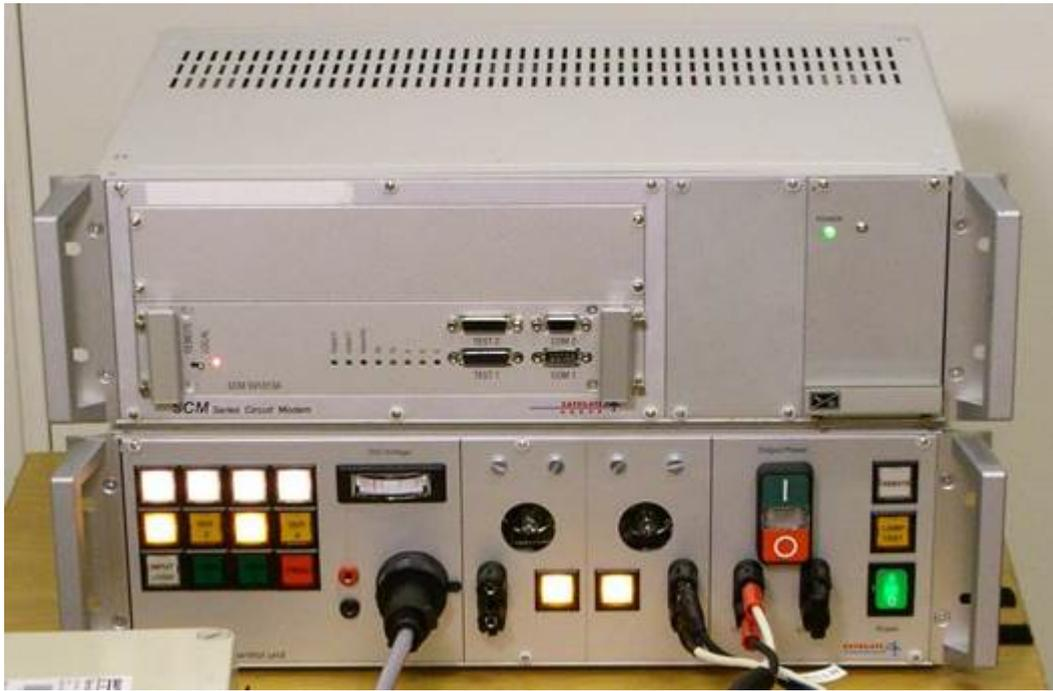
1. Verbinden Sie das mitgelieferte Kabel (594115) über **Output 1** oder **Output 2** mit dem RELIANCE IQ-Produkt. **Hinweis**: Der Kurzschlussstecker sollte mit dem **NICHT** verwendeten Ausgang (Output 1 oder Output 2) verbunden werden. Um identische Funktionalität zu gewährleisten, sind die beiden Ausgänge in Reihe geschaltet.
