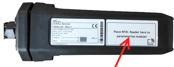
Das orangene Wellensymbol zur Verbindung auf dem Lesegerät zeigt an, wo sich die RFID-Antenne befindet, d. h. an welcher Stelle das Lesegerät an der Vorderseite des Moduls platziert werden muss, um eine Verbindung herzustellen.
