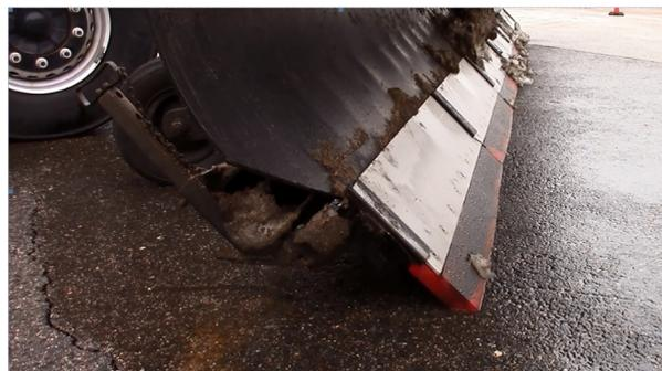
Fig.1 – *Lame de chasse-neige avec segments bien alignés*
