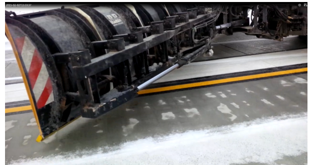
Abb. 5 - Schneepflug ohne Stützräder
