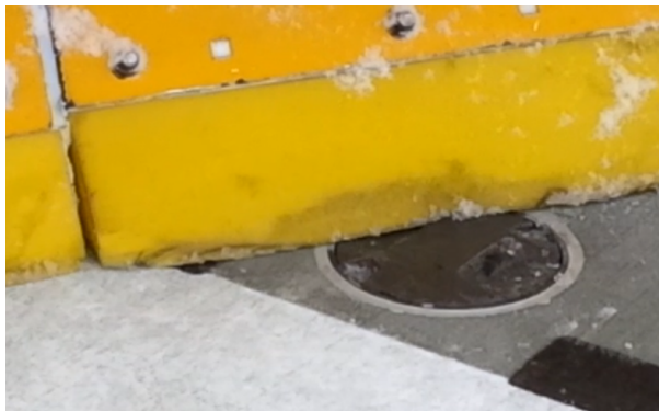
Abb. 3 - Direkt aufliegendes Räumschild
