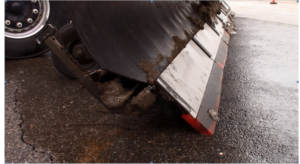
Abb. 1 - Räumchild mit perfekt fluchtenden Segmenten
