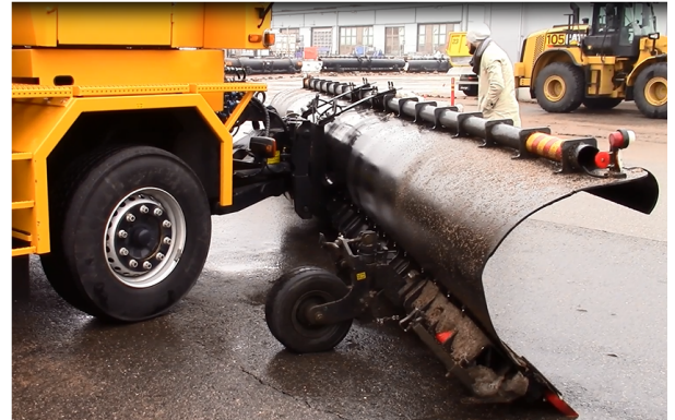
Abb. 4 - Schneepflug mit Stützrädern
