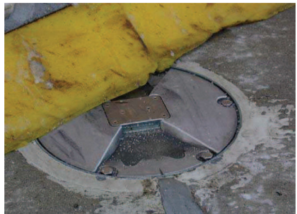
Abb. 2 - Schürfleiste mit abgenutzten Kanten und Versprünge zwischen den Segmenten
