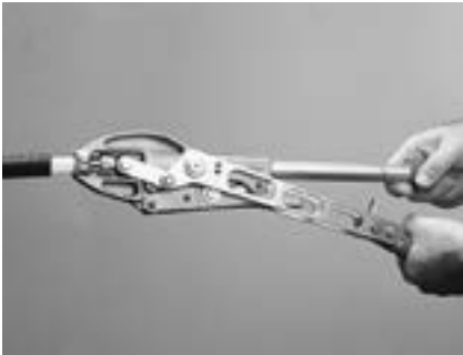
4. For å presse på kupling og blokke ut rør-enden, må man presse sammen det store håndtaket på montasjetangen.
