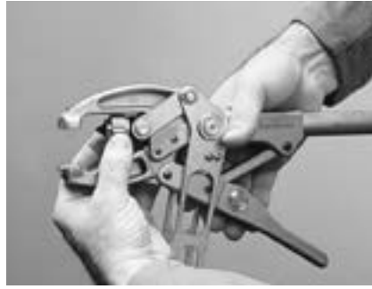
2. Monter kuplingen på montasjetangen med mutterens gjenge innover.
