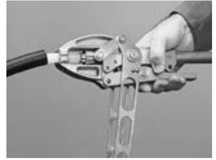
3. Før inn PEX-røret mot kuplingen og lås fast med det lille håndtaket på montasjetangen.
