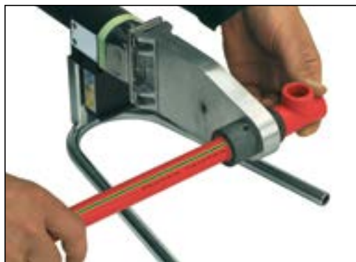
Oppvarming av rør og rørdel.
