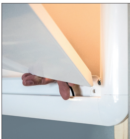
Dør monteres ved og sette inn bunnen først, ved bruk av plasthengsler tres disse inn i hull i bunn av dør.
