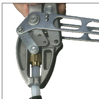
Tilpass lengden på det nye røret og monter klemunion.
